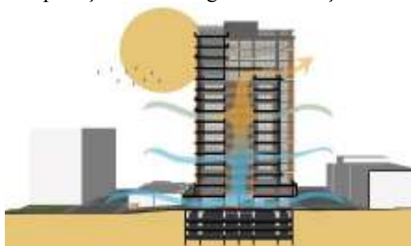
Figura 3: Diagrama da aplicação da estratégia de ventilação natural por efeito chaminé.
