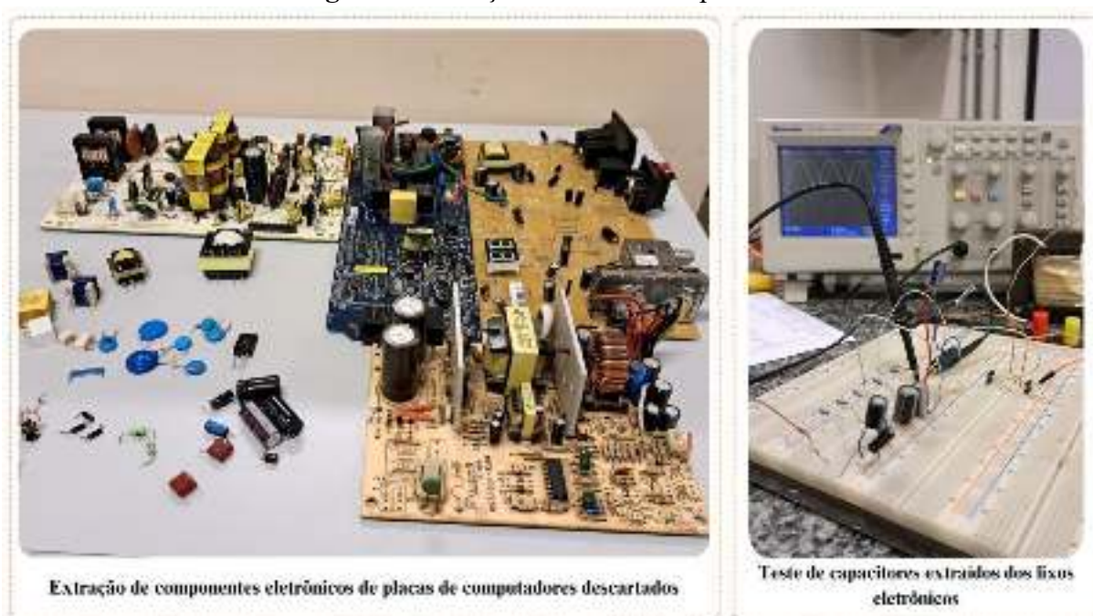
Figura 1: Extração e teste de componentes.
