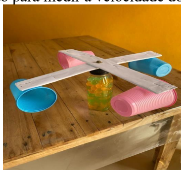
Figura 5 - Anemômetro utilizado para medir a velocidade do vento.
