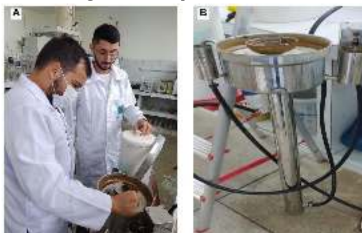
Figura 04 – Limpeza do destilador
