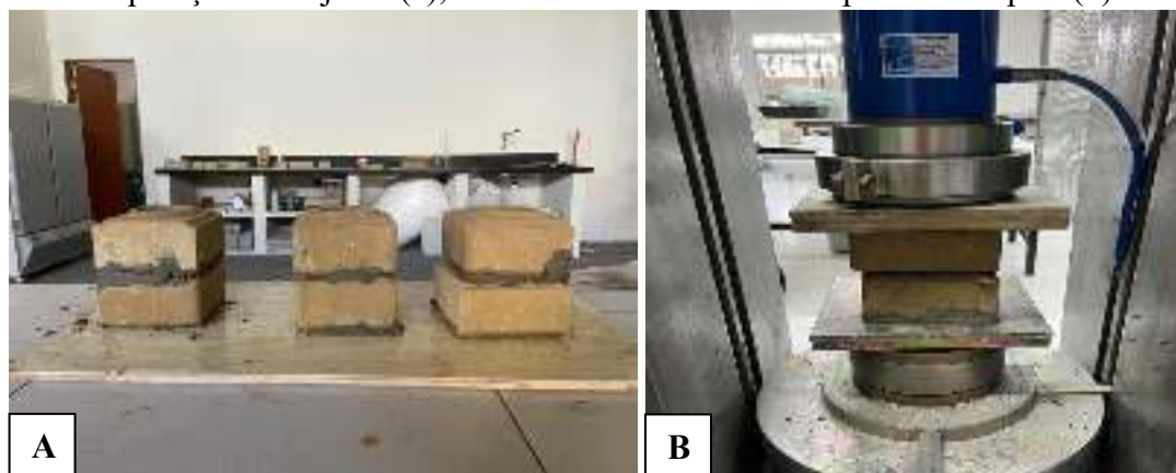
Figura 3. Preparação dos tijolos (a), Ensaio de resistência à compressão simples (b).
