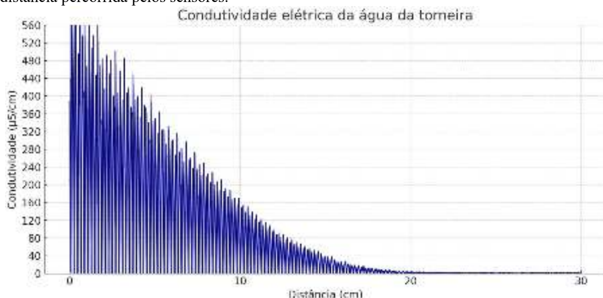
Figura 01: Representação gráfica da condutividade elétrica da água da torneira em função da distância percorrida pelos sensores.
