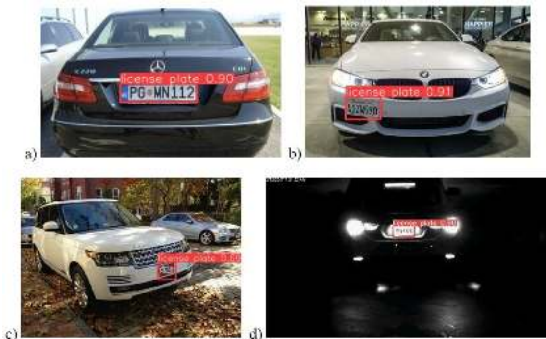
Figura 2 – Detecção de placas de veículos utilizando YOLOv8:
