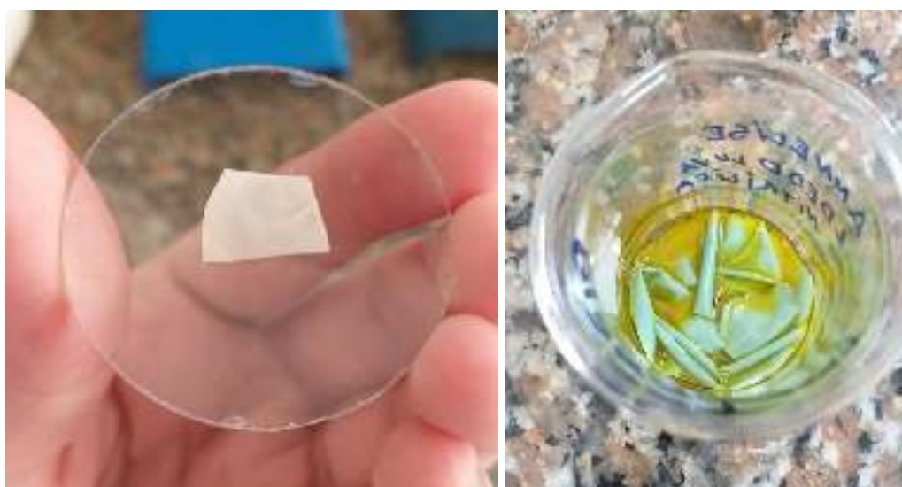
Figura 1 (esquerda). Luva de látex após contato de 14 dias com óleo de limoneno extraído no laboratório institucional.
