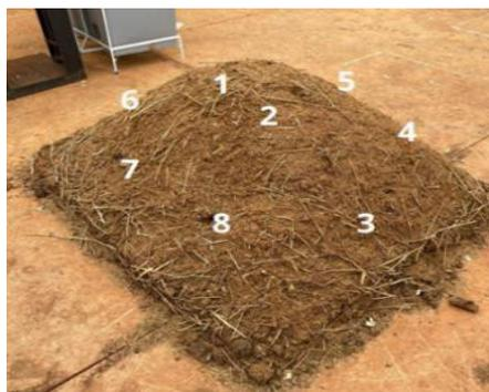
**Figura 2.** Pontos para realização das medições de temperatura
