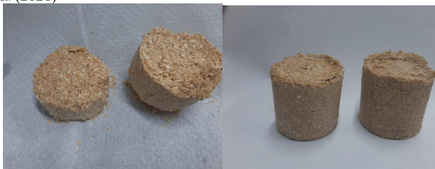
Figura 3 – Briquete com baixa compactação Figura 4 – Briquete 1 e briquete 2 FONTE: Fonte Própria (2021)
