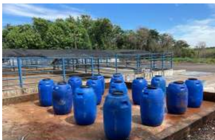
Figura 1: Recipientes onde foram feitos os ensaios de compostagem (as tampas foram retiradas após o início do experimento). Fonte: autoria própria.
