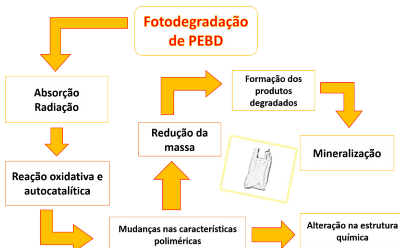
Figura 3: Rotas de reações durante a fotodegradação do polietileno de baixa densidade (PEBD)
