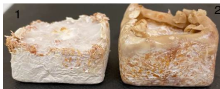
Figura 2: Intumescimento dos micomateriais de aveia: (1) MMA seco, e (2) MMA submerso em água destilada por 7h.
