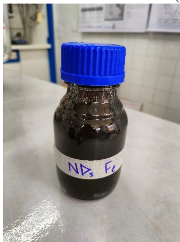
Figura 1 – Suspensão das nanopartículas de óxido de ferro (magnetita, Fe 3 O 4 ) obtidas.
