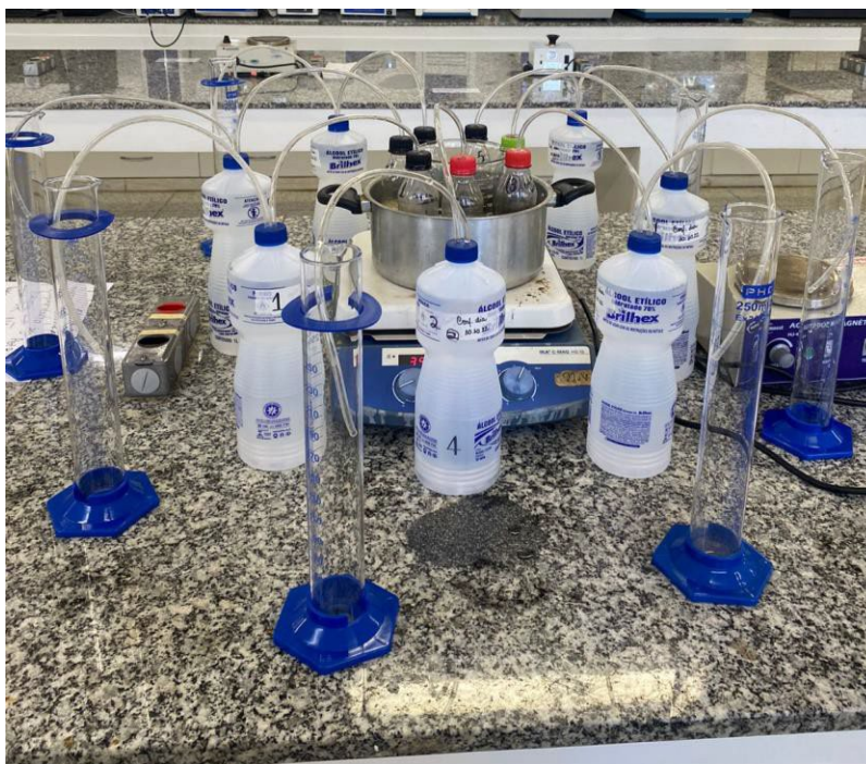
Figura 1 - Aparato experimental composto por 07 biodigestores mantidos à temperatura de 38°C conectados às suas respectivas câmaras de armazenamento de biogás e provetas para medição dos volumes de biogás produzido em cada biodigestor.
