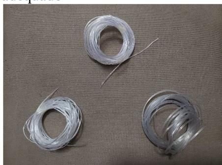
Para velocidades maiores que 3.5 mm/s, o filamento possui um formato curvado espinhoso, sem tempo suficiente para o PET se fundir em um formato circular, o filamento ficou rígido e com dobras. Para velocidades abaixo desta, o filamento produzido apresenta formato circular e tamanho consistente. Para reunir os resultados obtidos da realização dos testes de extrusão de forma resumida, foi elaborado a Tabela 1:
