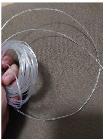
Com a utilização do filetador, para os testes seguintes, o filete não apresentou pontas, resultando em um filamento sem falhas de tamanho, com formato circular e sem “espinhos”, um filamento com forma apropriada, como apresentado na figura 3. Porém devido aos resíduos de cola restantes na superfície das garrafas, alguns filamentos apresentaram manchas ao longo do seu corpo.
