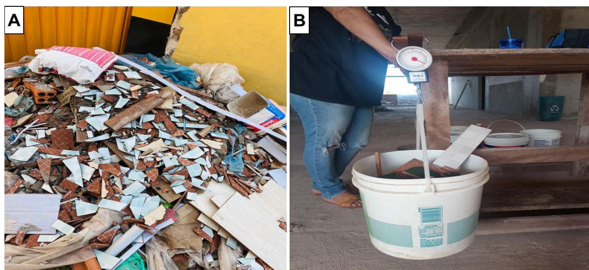
Figura 1 – Coleta de resíduos cerâmicos. A) coleta em entulhos em calçada publica; B) pesagem do material. Fonte: Acervo pessoal.
