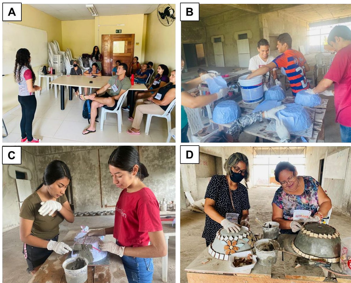
Figura 2- Oficina Arteduca: Uso de resíduos cerâmicos na produção de vasos para plantio de rosa do deserto. A) Palestra sobre Educação ambiental e práticas domésticas sustentáveis; B) Preparação do Molde plástico para fazer a cimentação da “casca”; C) Cimentação do molde plástico; D) Aplicação do mosaico. Fonte: Acervo pessoal.
