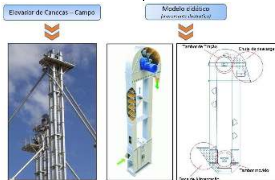
Figura 1: Elevador de canecas de campo e um modelo didático laboratorial.
