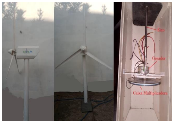
Figura 3 - Aerogerador e estrutura interna.
